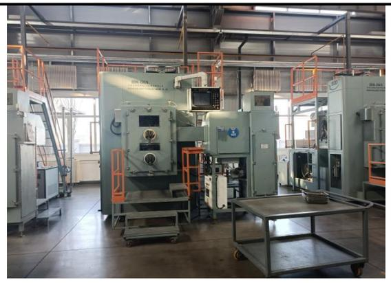
图 4-22 成型压机隔声
