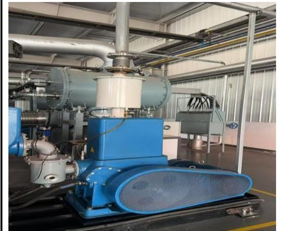
图 4-13 扩渗炉滤芯过滤器
