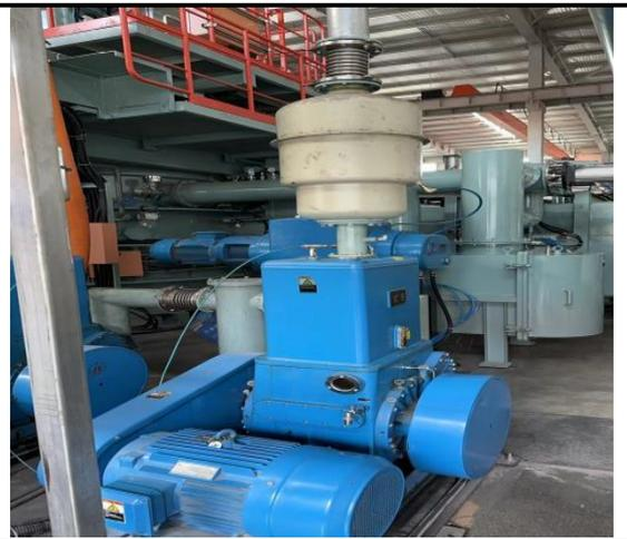
图 4-8 熔炼工序滤芯过滤器
