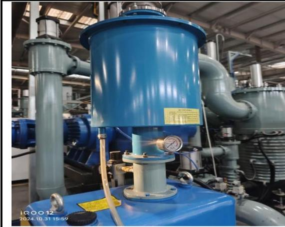
图 4-11 烧结炉滤芯过滤器
