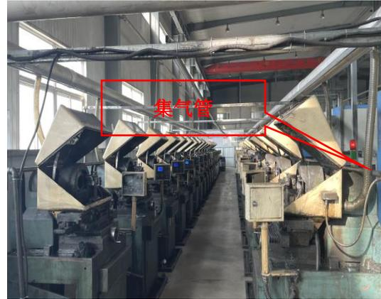
图 3-5 切割废气集气管
