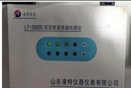
图 3-7 泄漏检测仪
