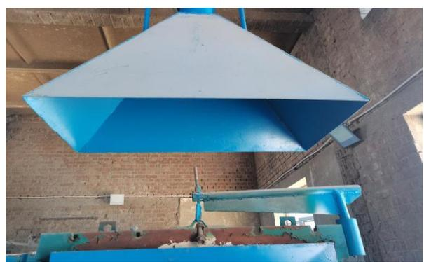
图 4-4 抛光粉前驱体生产上部集气罩
