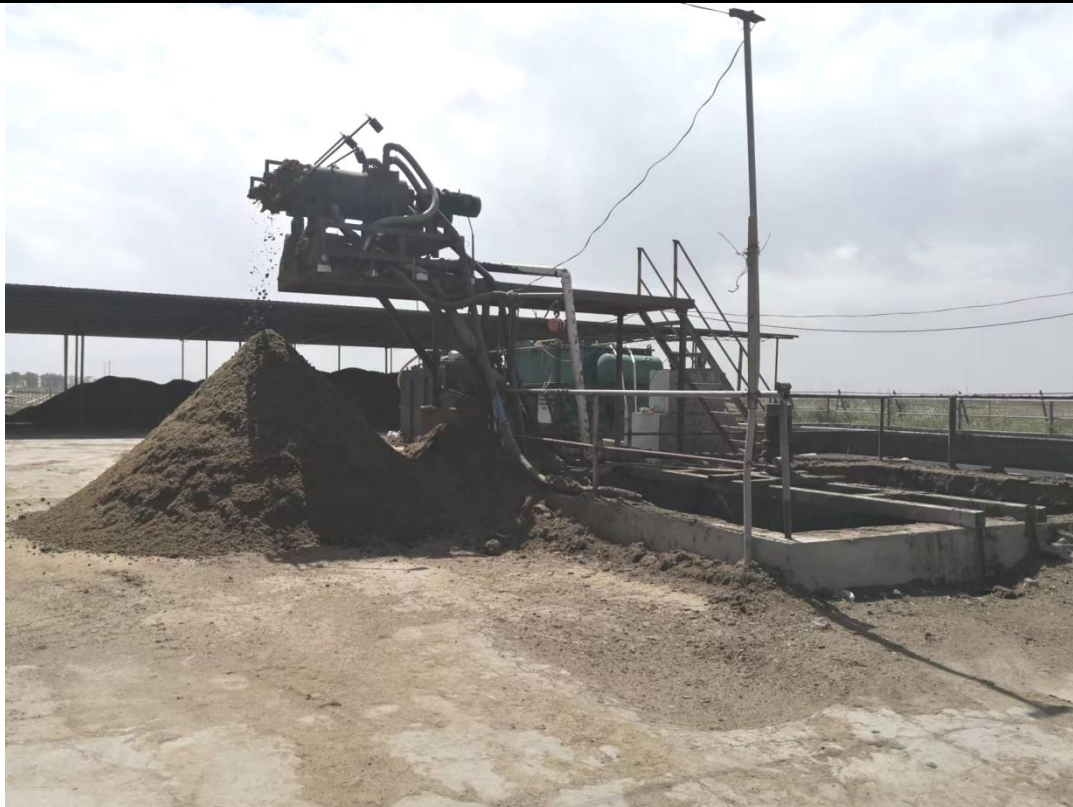
图 4-3 干湿分离机+接收池+厌氧发酵池
