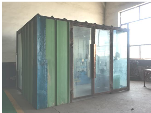
图 3-10 设备箱体隔音
