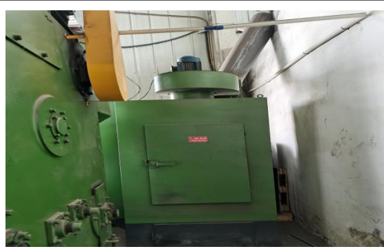
图 4-8 履带式抛丸机自带的过滤器
