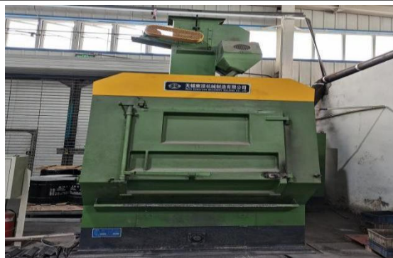
图 4-7 履带式抛丸机
