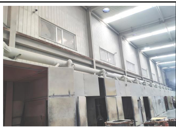
图 3-8 稀土合金生产电解槽
