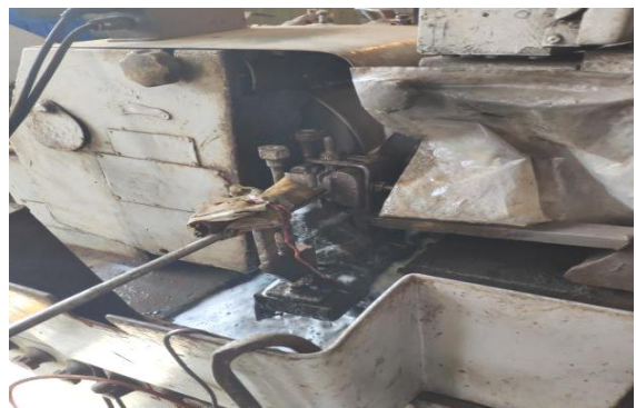
图 4-6 磨床水冷却循环水槽
