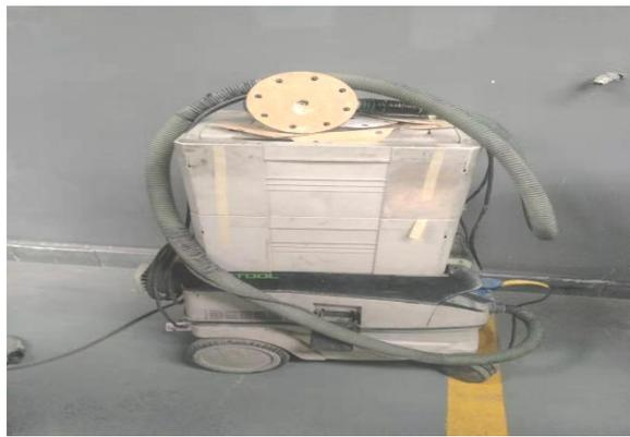
图 3-3 无尘干磨机（自带除尘器）
