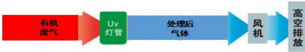
图2-5 本项目光氧催化法工作流程图
