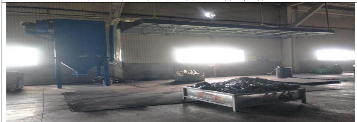
图 4-5 产品工业硅破碎区上方设置集气罩+布袋除尘
