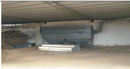
图 3-7 脉冲式布袋除尘器
