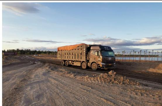
图 3-5 砂石料车苫盖运输进厂
