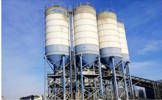
图 2-2 项目 120 型混凝土拌合站
