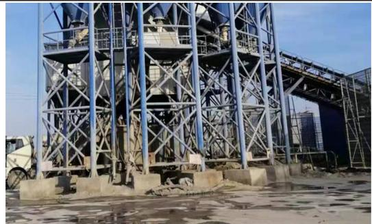
图 3-14 设备安装基座进行减震降噪
