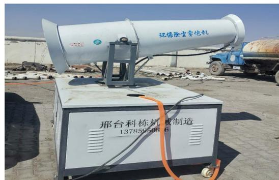
图 3-10 原料堆场除尘雾炮机
